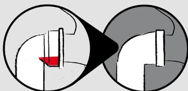
> DISEÑO "DESAGÜE +", SUPRIME LA RETENCIÓN DE AGUA EN LA SALIDA DEL WC Y ASÍ REDUCE EL RIESGO DE FUGAS.
