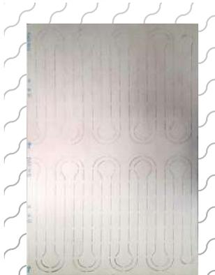
Panel Radiante de 2000x1200 compuesto de un panel de Placa de Yeso Laminado (PYL) de 12,5 mm de espesor, con marcado CE, tubo PERT con barrera de oxígeno de  $\Phi 8 \times 1$  mm, panel aislante en poliestireno expandido EPS200 ignífugo, euroclase E, dimensiones: 2000 x 1200, espesor 30 mm bajo normas UNI.
