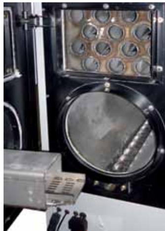
INTERCAMBIADOR Y CÁMARA DE COMBUSTIÓN CON SIN FIN DE EXTRACCIÓN DE CENIZAS.
