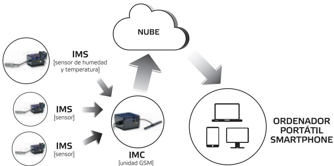
Los **SENSORES** del **IMS** miden la temperatura y la humedad de la habitación y envían la información al **IMC**, la **UNIDAD DE COMUNICACIÓN GSM**.
