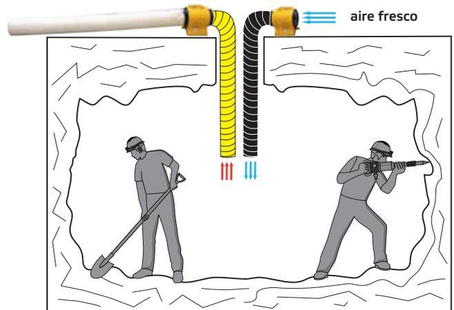
**Ejemplo: Trabajos en el sub-suelo. El aire fresco se introduce desde el exterior y el aire viciado se extrae y se filtra con la bolsa de polvo.**
