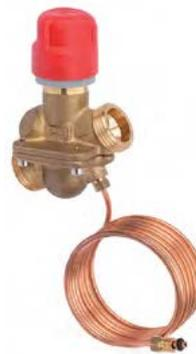
Válvula de presión diferencial combinada de equilibrado automático que incorpora un tubo capilar. Realiza 3 funciones: control de la presión diferencial del circuito al que abastece, control de zona y limitación de caudal. Admite el montaje de un cabezal termoelectrico para su apertura y cierre.
