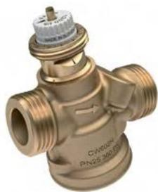
Válvula de equilibrado hidráulico dinámico que limita el caudal máximo de forma automática e independiente. Mantiene la presión diferencial a un valor constante una vez fijado un caudal en el volante. Admite el montaje de un cabezal termoelectrico para su apertura y cierre.
