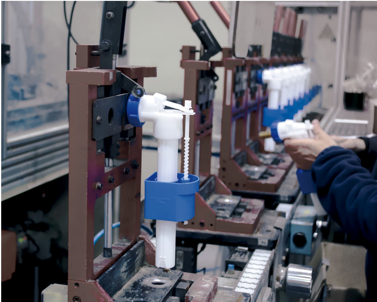
ESTACIÓN DE COMPROBADO GRIFOS SERVO
