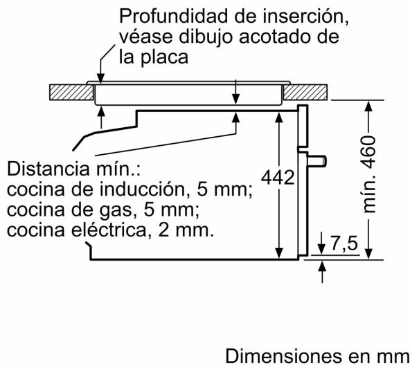
Si se instala el aparato compacto debajo de una placa, se debe respetar el siguiente grosor de encimera (incl., dado el caso, la estructura de soporte).
