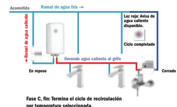
Una vez activado el sistema, el Bypass y el Módulo de Potencia se ponen en marcha para proceder a la recirculación del agua que está acumulada desde la caldera al punto de uso o grifo.
