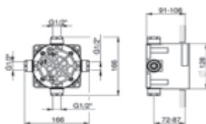
**Caja universal para realizar la preinstalación de fontanería y que una vez finalizada la obra se tenga la posibilidad de elección del uso bañera/ducha con funcionalidad termostática o monomando sin tener que realizar ningún cambio en la instalación empotrada.**
