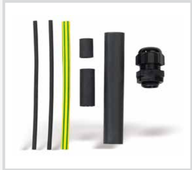
MVKITGR 3 tubos termorretráctiles para cables de alimentación y puesta a tierra, 1 tubo termorretráctil para aislar el cable de alimentación, 2 tubos termorretráctiles cortos para aislar los terminales del cable calefactor y 1 racor pasacables para cajas de distribución.
