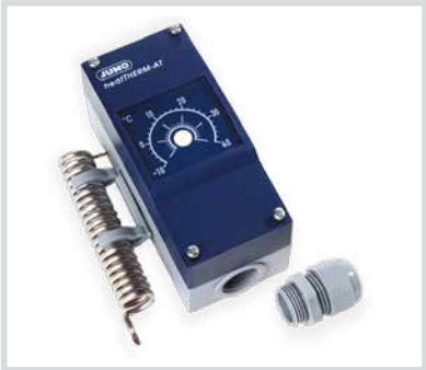
MVTH Termostato de ambiente para la alimentación del cable autorregulante. En caja IP54. Rango de regulación -10÷40 °C diferencial 1-2 K. Tensión 230 VCA Contacto 16A/230 VCA
