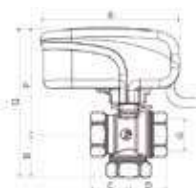
Válvula de zona motorizada con tapón obturador
