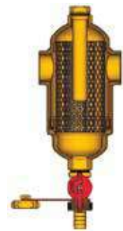
Esquema montaje accesorio: Desfangador + Sep. magnético
