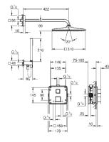
Compuesto por: Termostato de ducha para 2 salidas con cierre e inversor integrado (24 154)
