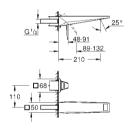
Palanca Moleteada Sólo parte exterior Necesaria parte empotrable 23 200 002 Tecnología GROHE Water Saving ahorro de agua con el máximo bienestar Caudal máximo a 3 bar: 5 l/min Caño con mousseur integrado Distancia entre centros 110 mm Longitud de caño: 210 mm
