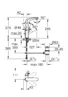
Eurostyle Monomando de lavabo de 1/2" Tamaño L Palanca metálica con hendidura GROHE SilkMove Cartucho de discos cerámicos 28 mm Limitador ecológico de temperatura
