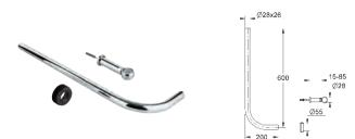
Cromo **Tubo de descarga** para fluxor de WC Ø 28 x 26 mm, **600 x 200 mm** Latón cromado Abrazadera para distancias del tubo a la pared de 15 - 85 mm Goma de enchufe
