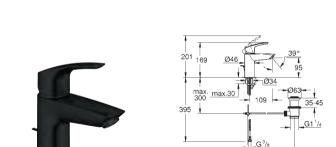
novedad 32 926 2433 141,68 Negro mate **Furosmart** Monomando de lavabo 1/2" Tamaño S Instalación en un solo agujero Palanca metálica **GROHE SilkMove Energy Saving** Cartucho de discos cerámicos de 28 mm con apertura en agua fría para mayor ahorro de energía Limitador de caudal ajustable Limitador de Caddar ajustable
