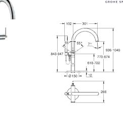
Sólo parte exterior Necesaria parte empotrable 45 984 001 Parte empotrable no incluida GROHE SilkMove Cartucho de discos cerámicos de 35 mm Inversor automático: baño/ducha Caño con mousseur integrado Longitud de caño: 301 mm Válvula anti-retorno en la conexión de salida de la ducha 1/2
