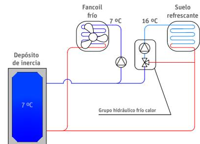
Conjunto formado por un grupo hidráulico con carcasa aislante y mezcladora de 3 vías con servomotor autónomo (sin necesidad de centralitas externas). El usuario podrá elegir la temperatura de impulsión tanto en calefacción como en refrescamiento.
