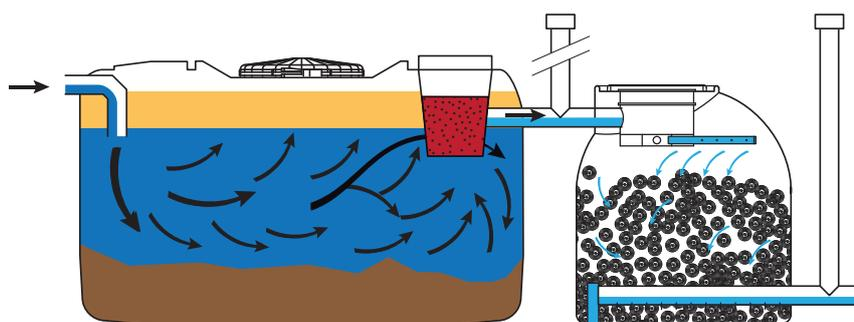
Conjunto autónomo de depuración biológica aeróbica de aguas residuales domésticas. Consta de una decantación primaria y un filtro percolador. Productos biológicos incluidos para la puesta en marcha. Rendimientos teóricos de eliminación de M.E.S del 90% y de DBO<sub>5</sub> del 76%.
