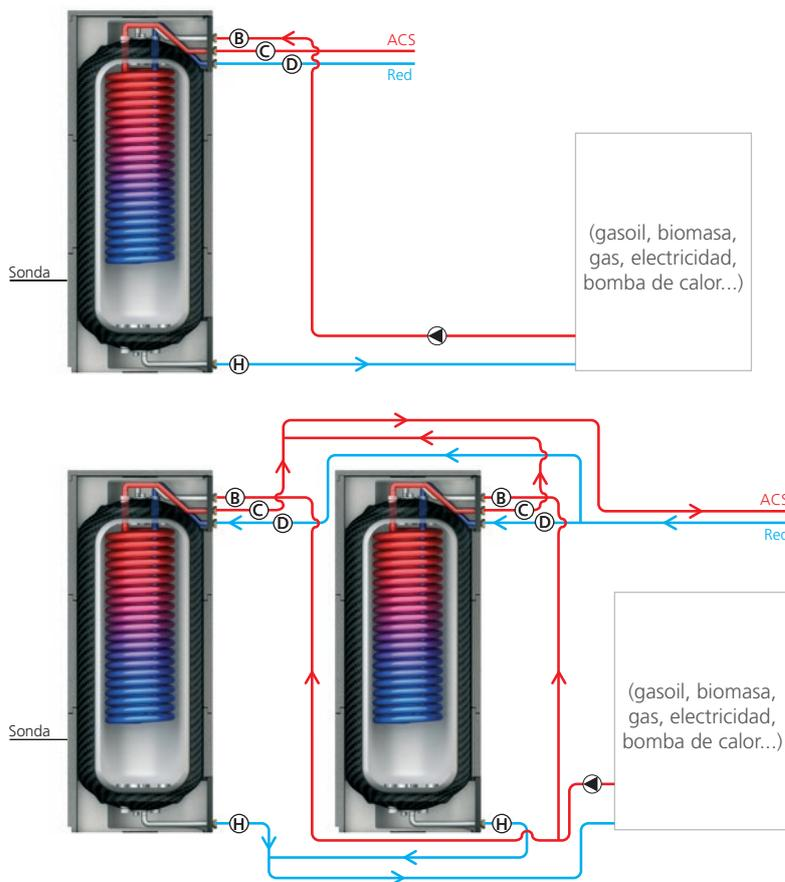
Esquemas de ejemplo para instalaciones tipo. A la hora de realizar la instalación se deberán tener en cuenta las normativas a aplicar en cada caso, así como los elementos de protección básicos de la instalación.
