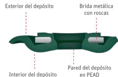
El sistema brida asegura la calidad del agua potable en todo momento ya que en ningún momento entra en contacto el agua con la parte metálica interna. Internamente la brida dispone de pared en PEAD y su estructura metálica sirve solamente para asegurar un mayor par de apriete de sus roscas, asegurando la estanqueidad de la conexión del accesorio de vaciado al depósito.
