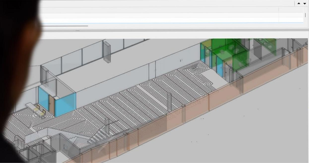
En la norma UNE-EN 1264 se especifica una serie de requisitos que se recomienda cumplir para diseñar un suelo radiante. Uno de los más importantes y donde la norma incide es el aislamiento térmico que debe existir bajo las tuberías para limitar el flujo de calor a través del suelo a las salas situadas inmediatamente debajo.
