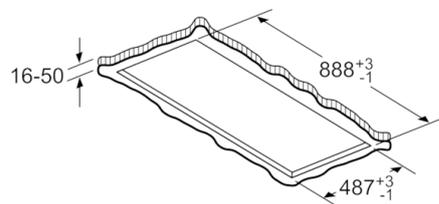
No montar el aparato directamente sobre tablas de yeso o materiales ligeros similares del falso techo. Se requiere una estructura inferior apta y que esté bien fijada al techo de hormigón.
