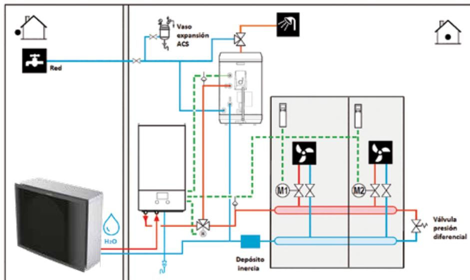
Esquemas de principio básicos. A completar según la dirección facultativa. Dependiendo del generador y emisores puede ser necesario aumentar la inercia del sistema.
