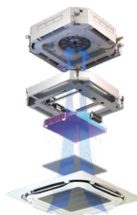
El filtro UV Streamer consigue la inhibición de virus y bacterias mediante combinación de la tecnología Flash streamer convencional, exclusiva de Daikin, con la **tecnología LED UV-C** y un **filtro antibacteriano/antivírico**.
