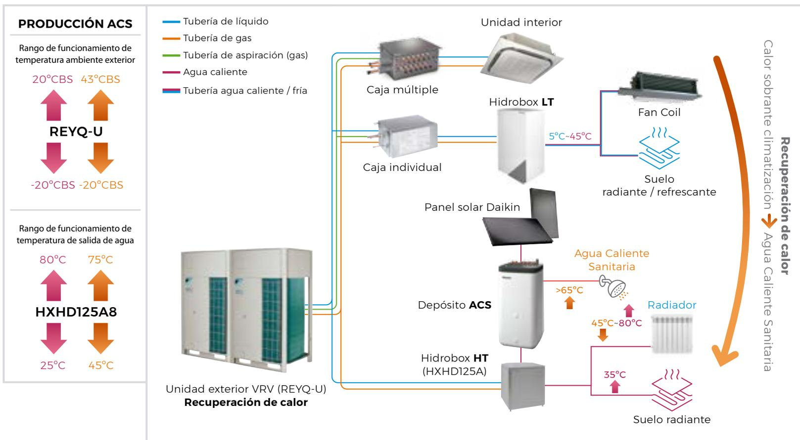
Nota: para producción de ACS con depósito externo es necesario la instalación de una sonda (5002145).
