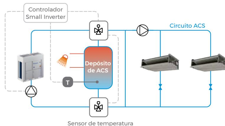
**Nota:** necesario incluir sensor de temperatura para el depósito EKRSCTDH. Distancia máxima 50 m entre la sonda y el controlador.
