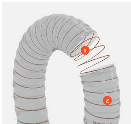
1. Espiral de acero cobreado. 2. Poliuretano transparente base poliéster.
