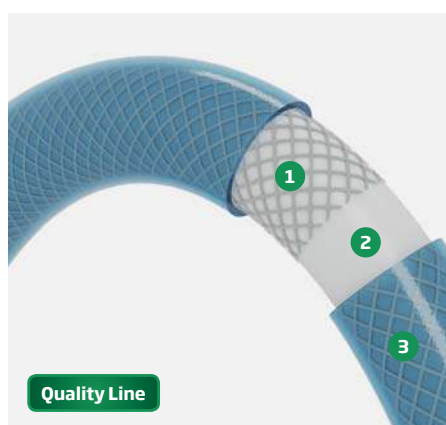
1. Capa intermedia: refuerzo de malla de hilo de poliéster. 2. Capa interior blanca de uso alimentario. 3. Capa exterior PVC azul transparente.
