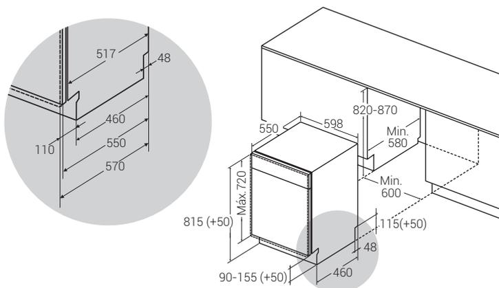
Esquema para los modelos: LVF68ITA, LVF66ITA y LVF63ITB
