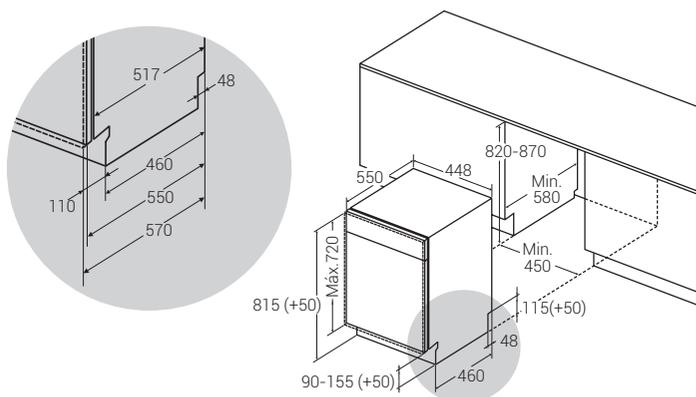
Esquema para el modelo: LVF453ITA
