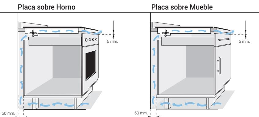
Nota: El ventilador de la placa deberá disponer de espacio suficiente para la entrada de aire.
