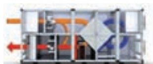
Deshumidificación mediante circuito Alfa
