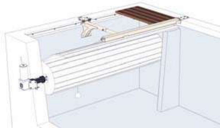
Instalación cubierta sumergida Roussillon Fosa Seca
