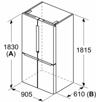
**A:** La parte frontal es ajustable desde 1830 hasta 1847, con las patas de nivelación totalmente extendidas
