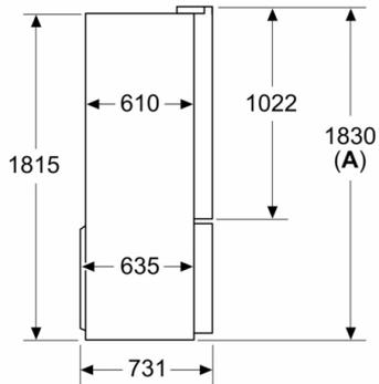
**A:** La parte frontal es ajustable desde 1830 hasta 1847, con las patas de nivelación totalmente extendidas
