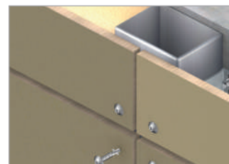
Fibrocemento sobre acero
