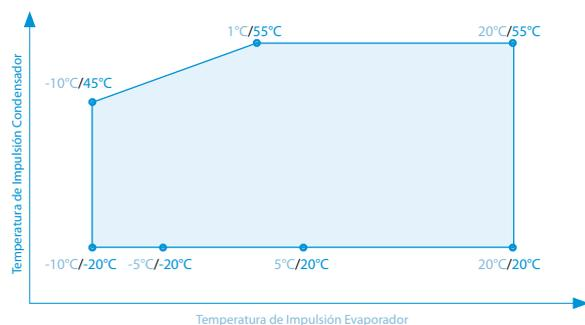
x°C / y°C : x temperatura de impulsión evaporador
