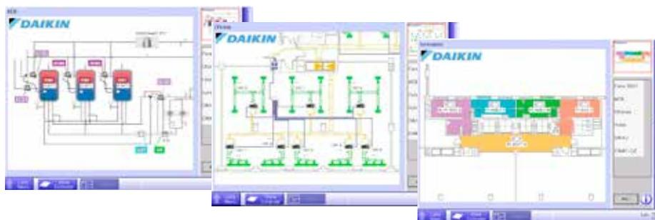
El nuevo intelligentTouchManager (DCM601B51) es un potente sistema de gestión centralizada táctil diseñado y optimizado para unidades VRV, capaz de controlar y supervisar los 20 parámetros de hasta 512 unidades interiores. (20 x 512 = 10.240 parámetros).
