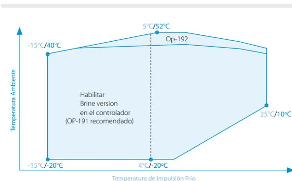
x°C / y°C : x temperatura de impulsión y temperatura ambiente
