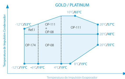
x°C / y°C : x temperatura de impulsión evaporador y temperatura de impulsión condensador
