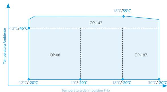
x°C / y°C : x temperatura de impulsión Frío
