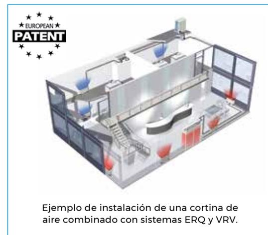
Ejemplo de instalación de una cortina de aire combinado con sistemas ERQ y VRV.
