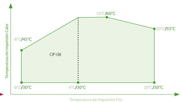
x°C / y°C : x temperatura de impulsión Frío y temperatura impulsión Calor
