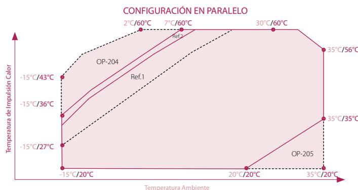
x°C / y°C : x temperatura de impulsión Frío y temperatura ambiente
