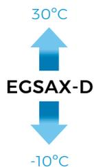
Rango de funcionamiento de temperatura de salida de agua
