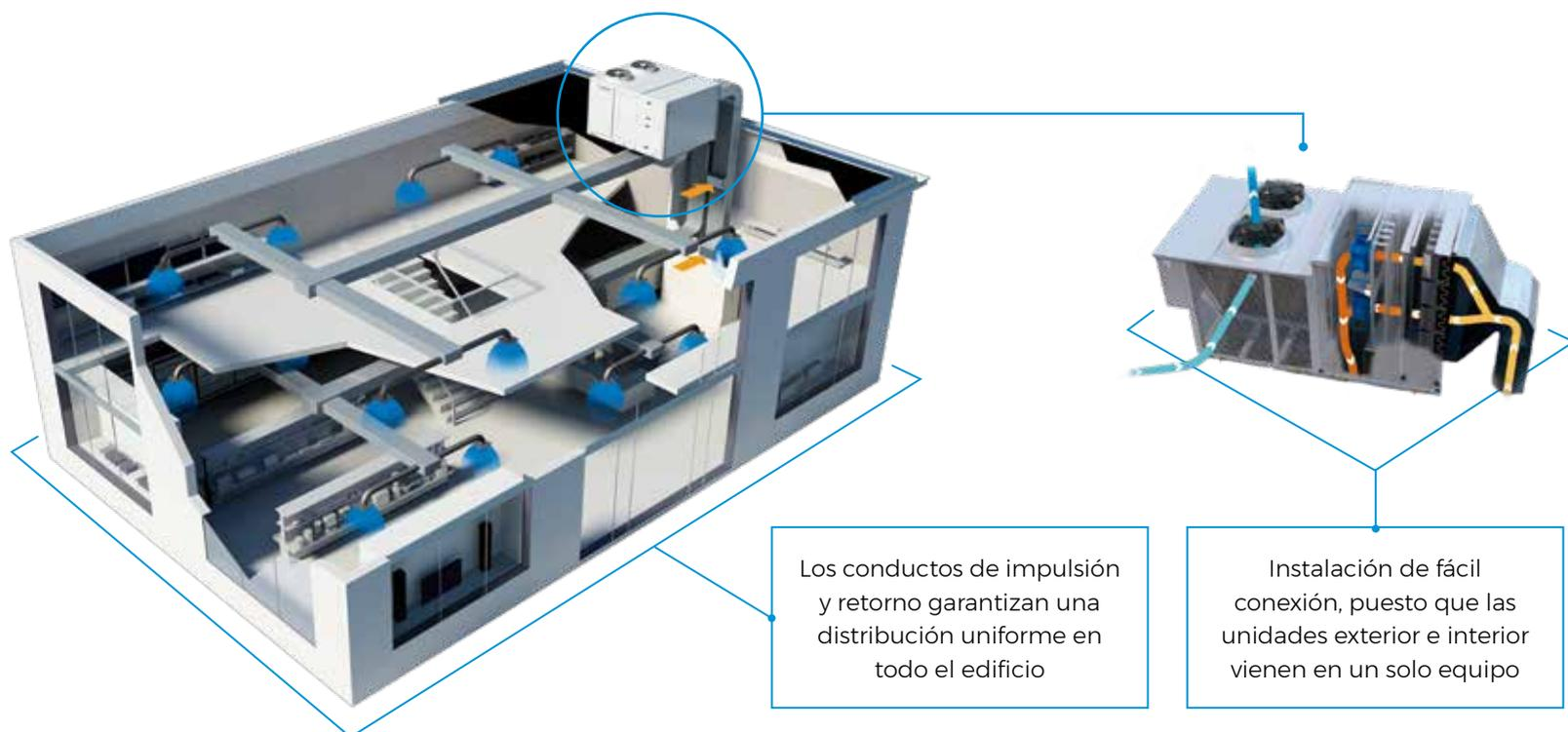
Los conductos de impulsión y retorno garantizan una distribución uniforme en todo el edificio
