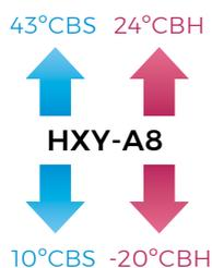
Rango de funcionamiento de temperatura de salida de agua
