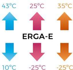
Rango de funcionamiento de temperatura de salida de agua
