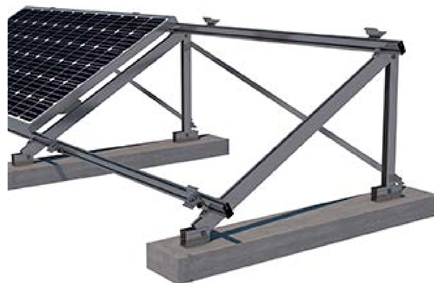
Instalación correcta de triángulo abierto sobre contrapesos de hormigón.
