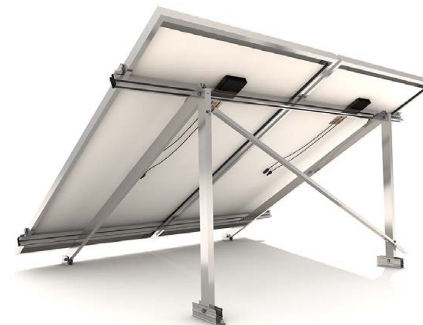
Instalación en cubierta de chapa. Todos los puntos de anclaje del triángulo deben siempre anclarse a la correa de la cubierta. En caso contrario se deberá colocar una subestructura. Consultar apartado de subestructuras de este catálogo.
