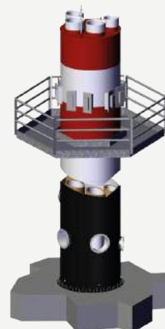
Chimenea autoportante con **conducto exterior resistente multiconducto** (contiene varios conductos aislados).
