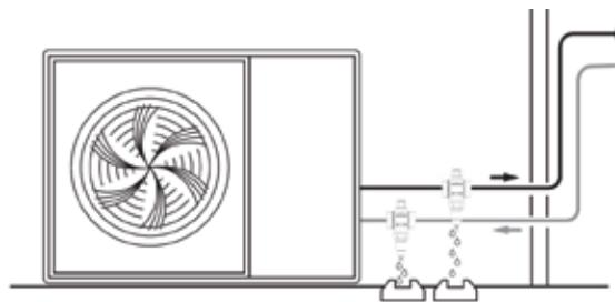
Protección de las Tuberías exteriores contra heladas.
