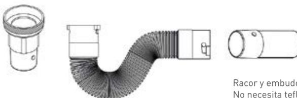
Racor y embudo con cierre tipo bayoneta. No necesita teflonar.
