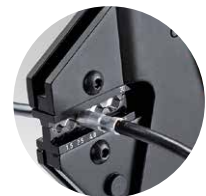
Alicate 97 43 200, con la mordaza Ref. 97 49 30, para conectores sin aislar
