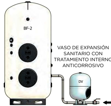
ENTRADA DE AGUA FRÍA SANITARIA
