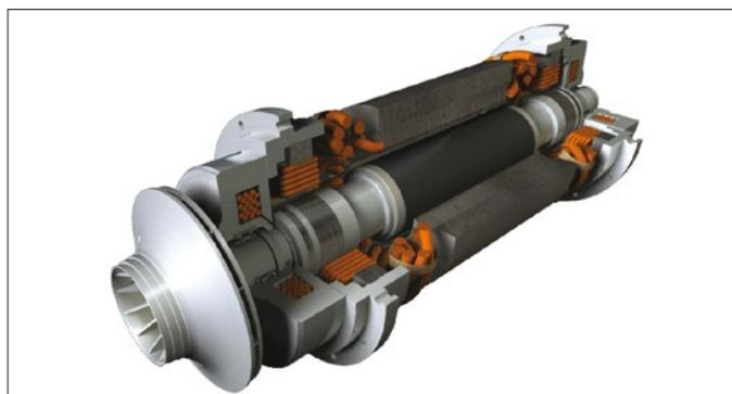
Para eliminar las pérdidas mecánicas por rozamiento en el eje, la enfriadora YMC<sup>2</sup> utiliza una tecnología de motor de imanes permanentes con cojinetes magnéticos activos.
