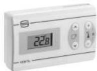
Termostato para Fan Coil digital (2 y 4 tubos) electrónico. Entrada cable "master". Selector 3 veloc. Opcional sonda a distancia tipo PTC2000, ej. Cod 5.266+3.970(Placa) Superficie. IP30 o cod 5.770 cable. IP65. Tensión 90...250Vac 50/60Hz. Relé on/off
