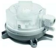
Presostato diferencial para aire, rango de 0,3 a 3 mbar (0,1 mbar de diferencial). Contacto Conmutado 3C. 1,5A(0,4)250Vac. Incluye 2 Cánulas. 2m de tubo flexible transparente Ø6mm. 4 tornillos para fijación. IP54. Prensaestopas PG16. Mínima compra 5ud
