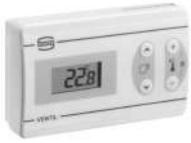
Termostato para Fan Coil digital (2 tubos) electrónico. Entrada cable "master". 3 puntos o todo/nada 2 entradas para control de climatización, por apertura de ventana y contacto tarjetero de puerta. Tensión 90...230Vac 50/60Hz. Opcional sonda a distancia
