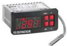
Termostato panelable 1 sonda y 1 relé a 230V~. Escala -40° a +140°C. Relé 12A, sonda incluida tipo PTC2000 de 1,5m. Puede leer PT1000 y NTC10K. Caja para IP65 de superficie, opcional (cod. 7.637)
