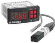
Control panelable a 230Vac. La entrada 1 es para sonda 4a20mA, actua sobre relé 1 (16A), puede leer cualquier magnitud (humedad, presión, etc) y la 2 es para sonda de temperatura NTC10K, PTC2000 o PT1000, actua sobre relé 2 (5A). Sondas no incluidas
