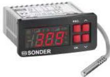
Termostato panelable 1 sonda y 2 relés con zona neutra a 230V~. Puede hacer 2 etapas de calor, 2 etapas de frío o una de frío y otra de calor. Relé 12A. Sonda PTC2000 de 1,5m incluida. Puede leer NTC10K y PT1000
