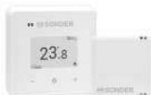
Termostato de tinta electrónica, Sólo calefacción, programable, montaje mural, acción modulante. PID, programación y bloqueo teclado desde la App. Dim. 105x105x40mm. y 76x76x30mm. Sin alimentación 230V a termostato. Control de ACS
