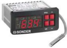
Doble termómetro panelable con décimas y memoria de temperatura máxima y mínima. Alimentado a 230Vac. Enchufar sonda y funcionar, se suministra con 1 sonda PTC2000 de 1,5m. Adicional comprar código 4.343. Puede leer PT1000 y NTC10K
