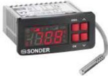
Termostato panelable 1 sonda y 2 relés maniobra y alarma a 230V~. Relés de 12A. Sonda PTC2000 de 1,5m incluida. Puede leer PT1000 y NTC10K. Caja para IP65 de superficie, opcional (cod.7.637)
