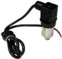
Transductor de presión rango 0 a 16bar, salida 4 a 20mA rosca 1/4"gas macho, cable incluido de 1m
