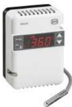
Doble termómetro con décimas y memoria de temperatura máxima y mínima. Alimentado a 230Vac. Montaje de superficie. Enchufar sonda y funcionar, se suministra con 1 sonda PTC2000 de 1,5m. Adicional comprar código 4.343. Puede leer NTC10K y PT1000
