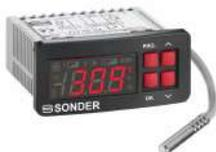
Termostato panelable 1 sonda y 2 relés para zona neutra, alimentado a 12...24Vac/dc. Puede hacer 2 etapas de calor, 2 de frío o 1 de calor y 1 de frío. Relés de 12A. Sonda PTC 2000 de 1,5m incluida, puede leer NTC10K y PT1000
