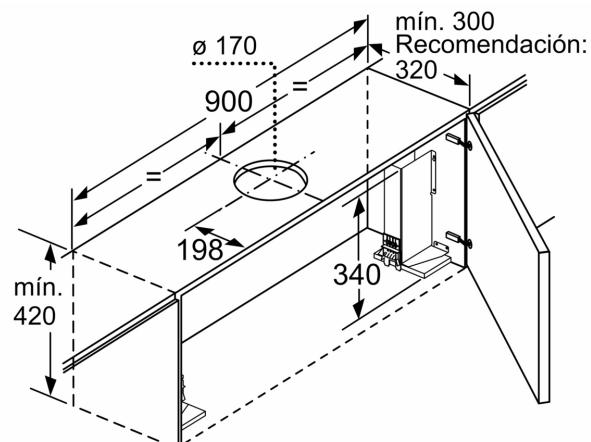
Para el montaje de la campana telescópica de 90 cm
