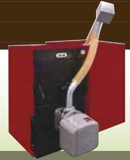
La caldera de Biomasa Policombustible SFL tiene una gran capacidad de cámara de combustible, lo que supone una gran ventaja a la hora de trabajar con leña. Tanto el regulador termostático (incorporado en la caldera) como la bomba, el vaso de expansión y la válvula de seguridad han de ser instalados por el instalador (no incorporados).
