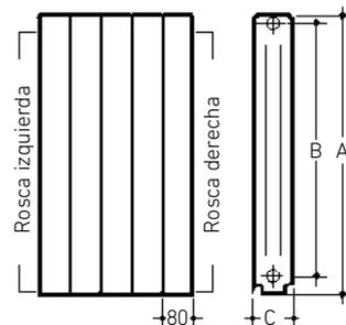
Accesorios no incluidos compuestos por: tapones y reducciones, pintados y cincados con rosca a derecha o izquierda, juntas, soportes, purgador automático PA5-1" (D ó I) y spray pintura para retoques.
